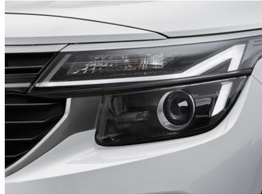
Проекционные фары со светодиодными ходовыми огнями DRL
